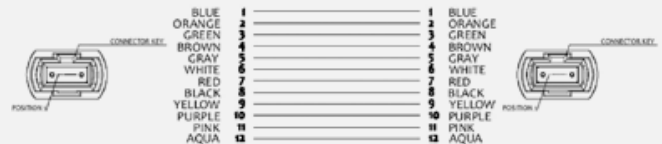
Belegung des Trunkkabels 12-fasrig
