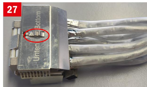
Oder der Anschluss am Potentialausgleich kann optional mittels FASTON-Stecker (2,8 mm) am Schirmblech des Moduls erfolgen.
