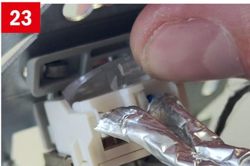
Den Hebel mit dem Schieber bis zum Anschlag nach oben drücken.
