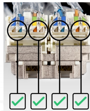
Abb. 3: Sichtfenster zur visuellen Kontrolle der Beschaltung
