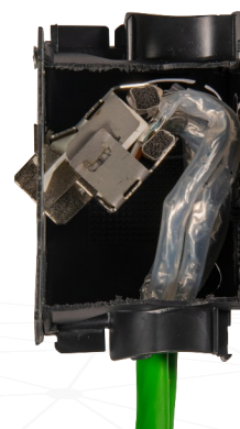
Abbildung 3: Buchse in flacher Schalterdose (Tiefe: 46 mm) inkl. rückwärtigen Schirmungsblech (Einbautiefe Buchse: 25,5 mm)
