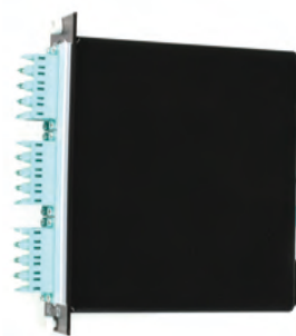
MTP®-/MPO-Modul (3 HE, 7 TE) für bis zu 24 Fasern. Dient zum Einbau in Modul- und Baugruppenträger. Rückseite mit MTP®-/MPO-Kupplungen.
